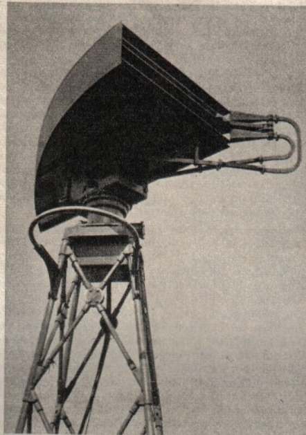
Die Drehantenne der Decca-Meßfunkanlage; oben Sendung, darunter Empfang. Besonders kurze Zuleitungen zum unmittelbar angebauten Verstärker vermeiden Störungen und Verluste
